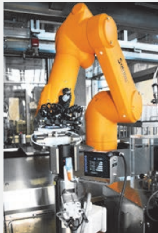
▲ Die gerekenariseerde robot waarmee Syngenta daagliks honderde verskillende formuleringstoevoegings toets om te sorg dat die aktiewe bestanddeel en bymiddels in harmonie met mekaar saamwerk. Dit sorg vir die wêreldklas effektiwiteit en selektiwiteit van ons produkte.
